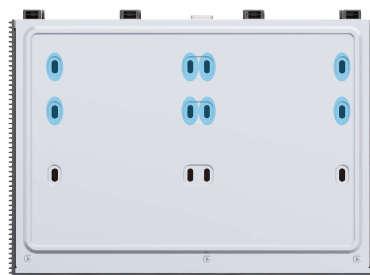
Instalacja dysku twardego 3,5 cala
